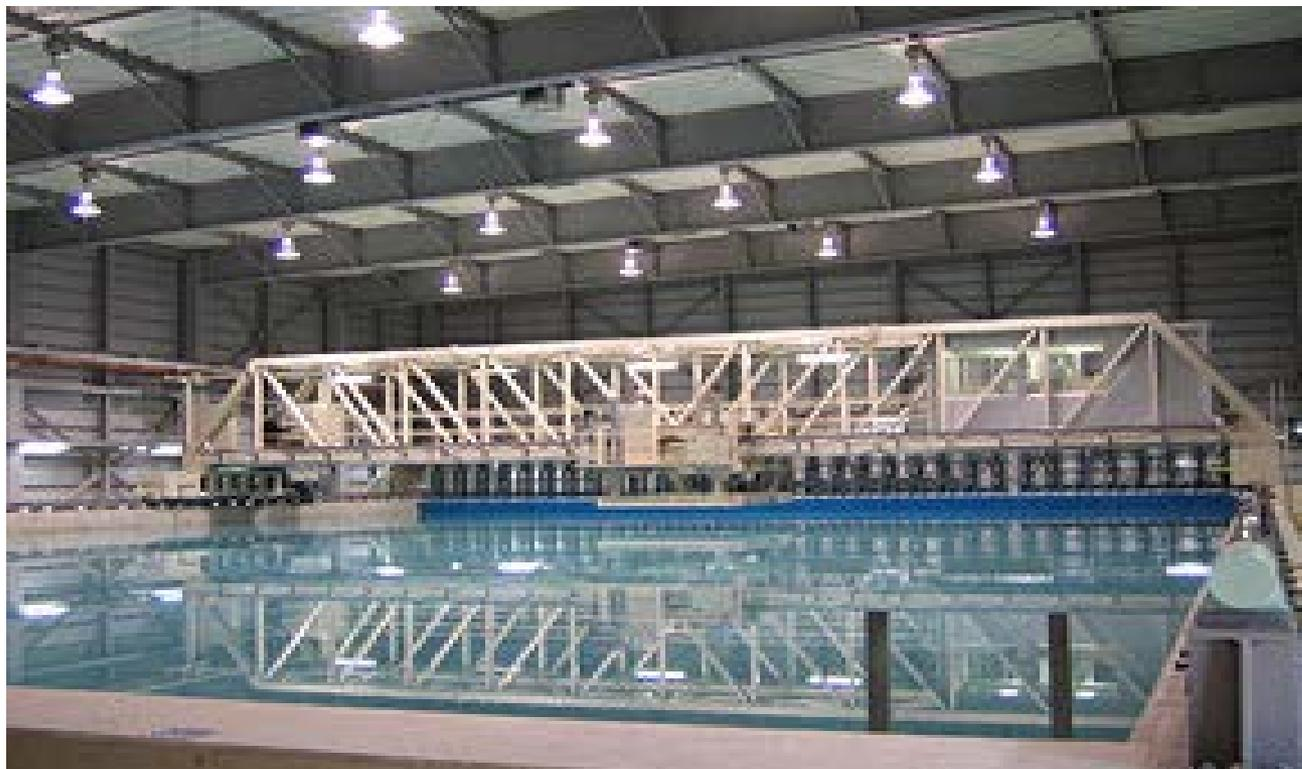
船舶運動性能試験水槽は、水槽本体と模型曳引車、プランジャー型造波装置によって構成されています。水槽本体は長さ38.8m、幅24.4m、水深2mです。水槽底部を高精度で平坦に仕上げたことにより、世界的にも数少ない浅水域を対象とした浮体運動の実験が実施可能な水槽となっています。
